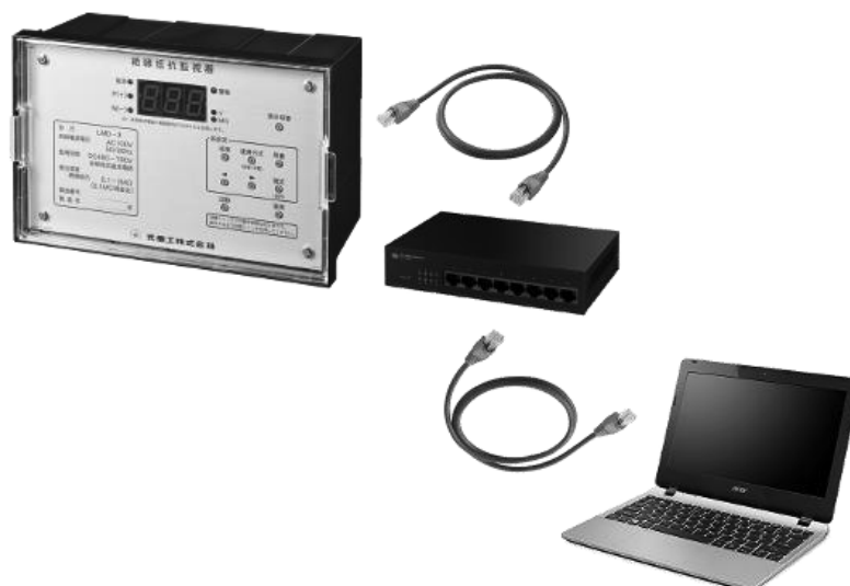
図 5-2 LMD-3 をパソコンネットワーク内に接続(LAN ストレートケーブル使用)
