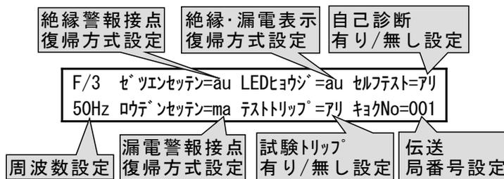
例えば、「絶縁警報接点復帰方式:自動復帰」、「絶縁・漏電表示復帰方式:自動復帰」、「自己診断有り/無し:有り」、「漏電警報接点復帰方式:手動復帰」、「周波数:50Hz」、「試験トリップ有り/無し:有り」、「伝送局番号:001」の場合、左画面が、左方向にスクロールして表示されます。(「au」は auto(自動復帰)、「ma」は manual(手動復帰)の略表示です。)
