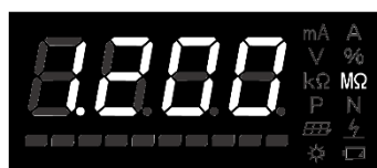
図 5.3-2 電路全体の絶縁抵抗表示
