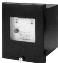
絶縁監視電圧装置 LNV-1B(以下 LNV-1B)は、 $I_{gr}$  方式で絶縁を監視するための基準電圧信号(20Hz、10V)を発生する装置で、変成器(GM30B)と組み合わせて使用します。
