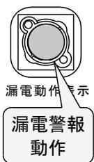
漏電監視部が動作した場合、動作した LIG-12 の監視する電路に漏電があると考えられます。漏電電流が流れ続けると、機器の破損や焼損などの事故につながりますので、迅速に漏電箇所を探し出して、復旧する必要があります。
