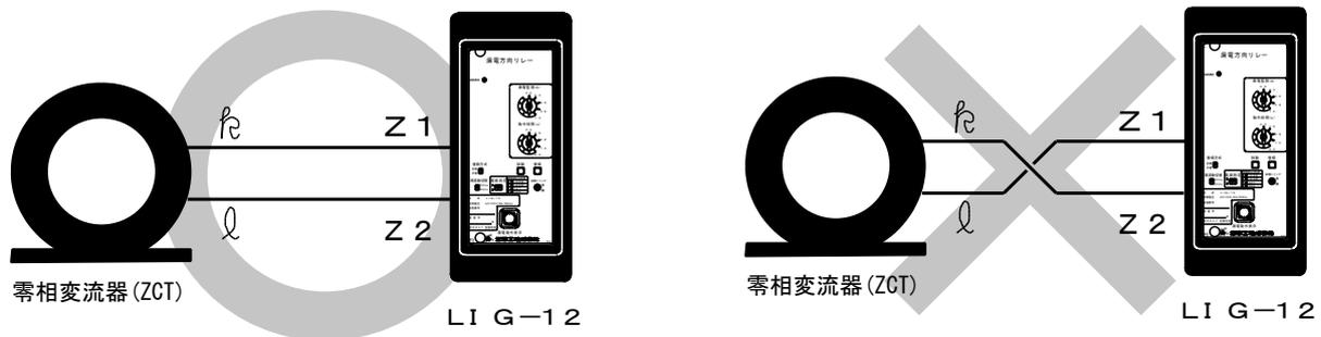
漏電方向リレー(LIG-12)は、ZCTで検出した電流の大きさだけでなく、位相も検出しておりますので、配線の極性が間違っておりますと、不要動作や不動作の原因となります。そのため
