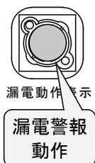
漏電警報部が動作した場合、動作した LIG-11 の監視する電路に漏電があると考えられます。
