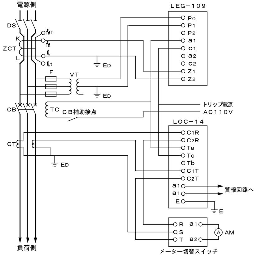
電流引き外しの場合（AC110V, PO-P1 端子接続の場合）
