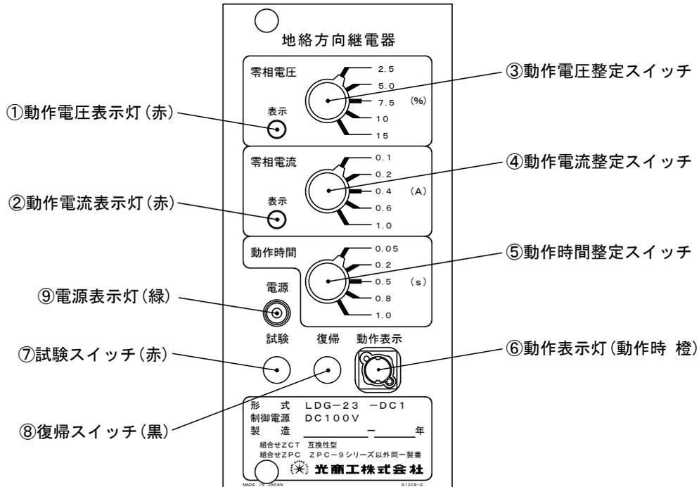
※ 3.3kV 電路用の動作電圧整定値は 5-10-15-20-30(%)です。(ZPC 使用時)
