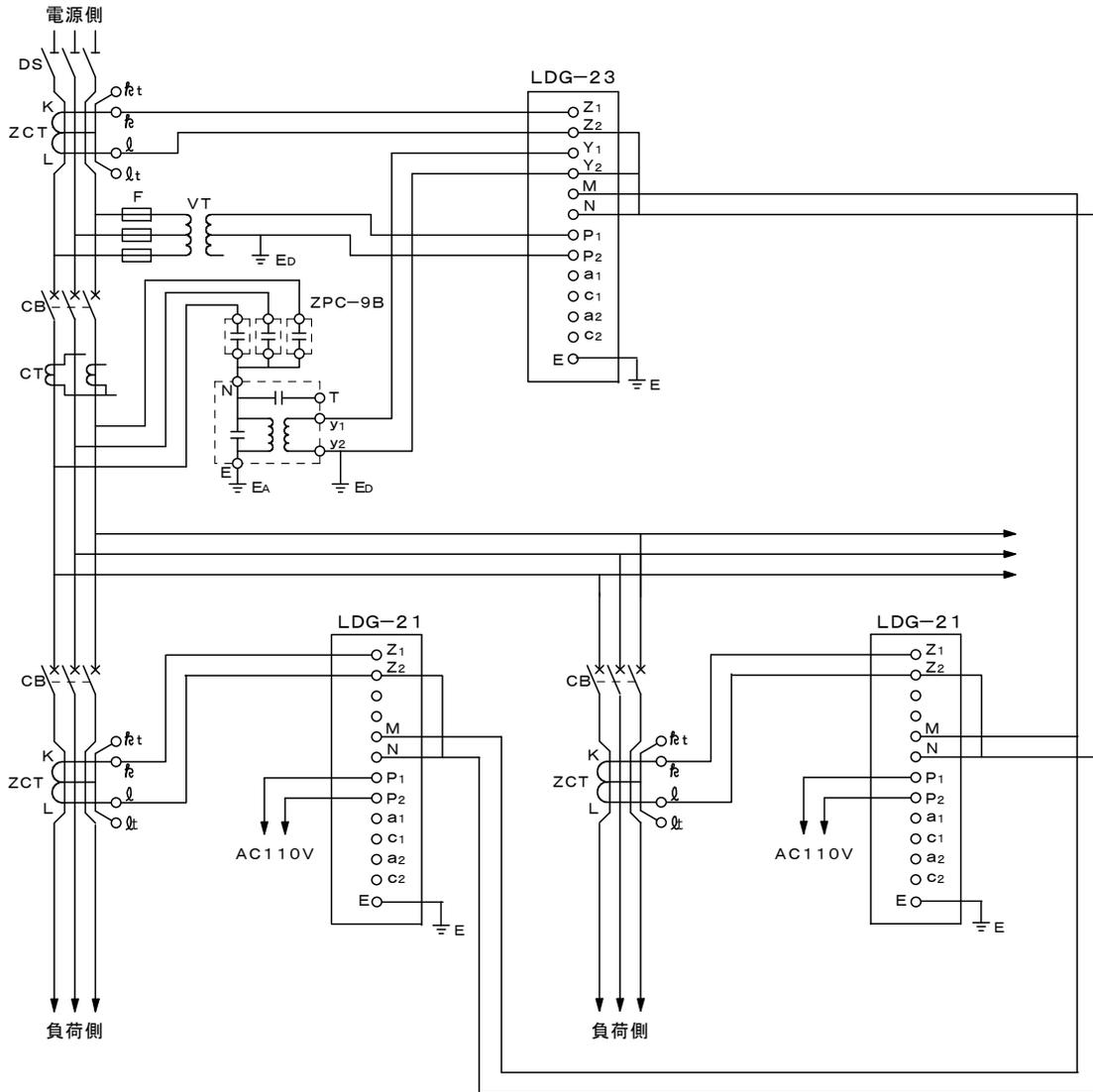
多分岐回路の場合 (LDG-23K, LDG-21K, LOC-13 と ZPC-9B の場合)
