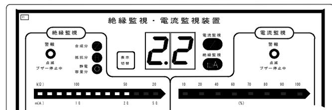
状態 : 静電容量分電流表示が大きい場合はコンセントに ME 機器等が多数接続されていることが考えられます。
