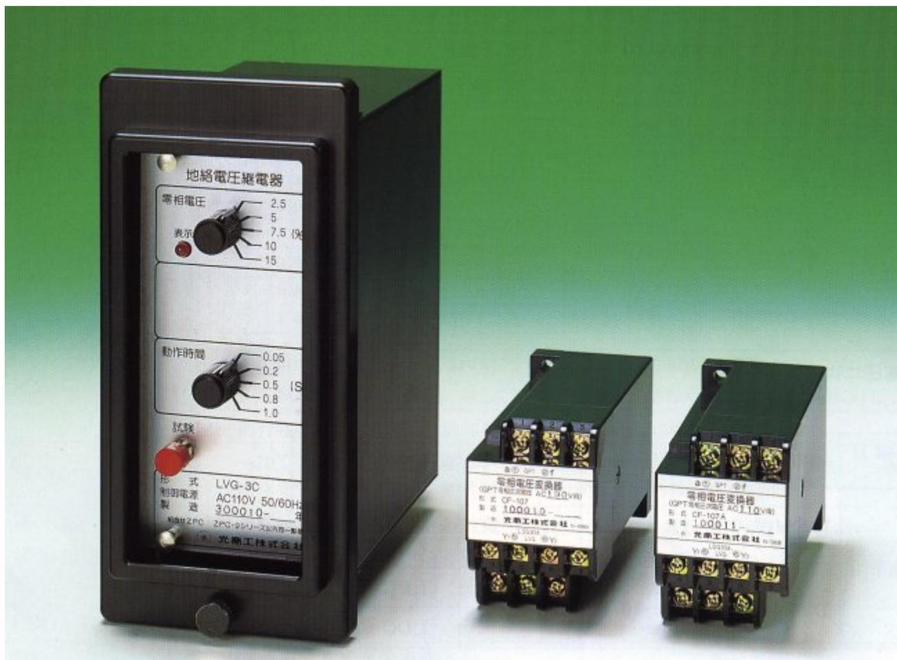
LVG 地絡電圧継電装置は 6.6kV または 3.3kV 高压電路用の零相電圧継電器で、高压受電の場合には零相蓄電器、特別高压受電の二次側においては接地形計器用変圧器及び零相電圧変換器と組み合わせることにより、零相電圧を検出し地絡方向継電器 LDG-21・21K または LDG-21-DC1 と併用して、高压電路の地絡保護を行ないます。
