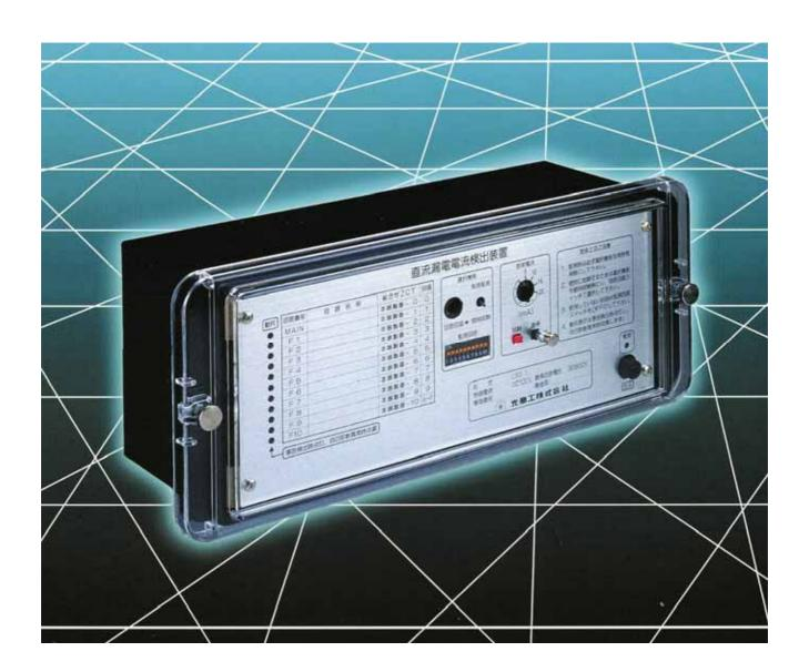
直流漏電電流検出装置と直流零相変流器の組み合わせからなり、主として DC600V 以下の電路の漏電検出を目的とし、漏電電路をオートスキャンする機能と自己診断機能を持った直流漏電電流検出装置です。
