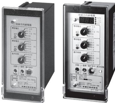
主に単回路用として使用される地絡方向継電器です。零相電圧、零相電流を検出できます。電圧要素はMN信号としてLDG-71・81シリーズに供給できます。LDG-83Aシリーズは伝送機能を搭載しています。
