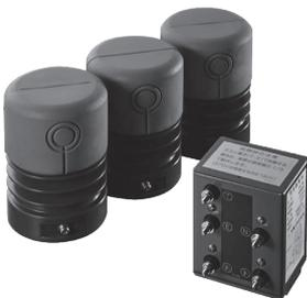
地絡電圧を検出する碍子形のコンデンサです。LDG-73・83またはLVG-7・8と使用します。碍子形コンデンサ EPD-2A×3、変成器 CF-71A×1、シールド電線 CF-89×1、高圧絶縁カバー CF-93×3で構成されています。3.3kV電路用やシールド電線 CF-89 3m 品等は特注 (ZPC-9BS) で対応しています。
